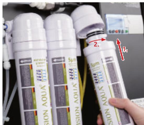
Setzen Sie die neuen Filterkartuschen in den Filterköpfe ein und drehen Sie dabei die Filterkartuschen um 90° im Uhrzeigersinn. Gehen Sie bei der zweiten PP Vorfiltereinheit auf die gleiche Weise vor.
