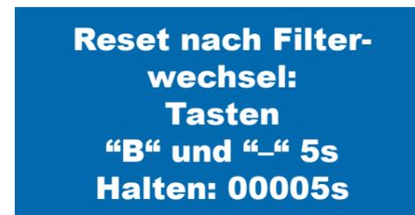
Um das Filterwechselintervall zurückzusetzen, müssen Sie im Betriebsartenmenü die Tasten (B) und (-) mindestens 5 Sekunden gedrückt halten.
