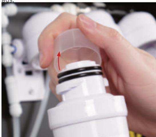
Bevor Sie die neuen Filtereinheiten einsetzen, nehmen Sie die Schutzkappe von den Filtern ab. Diese können Sie ganz einfach nach oben wegdrücken.
