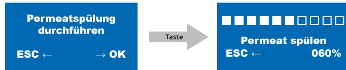
Sobald die Auswahl mit der **OK-Taste** bestätigt wird, spült das System das Permeat. Mit der **ESC-Taste** gelangen Sie wieder in das Betriebsarten-Menü. Sobald die Spülung beendet ist, geht das System automatisch in das Betriebsarten-Menü zurück.
