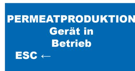
Um die Trinkwasserproduktion zu beenden, schließen Sie den Wasserhahn. Ist die Wasserproduktion beendet, bereitet das System den Standby-Modus vor. Auf dem Display erscheint folgende Meldung:
