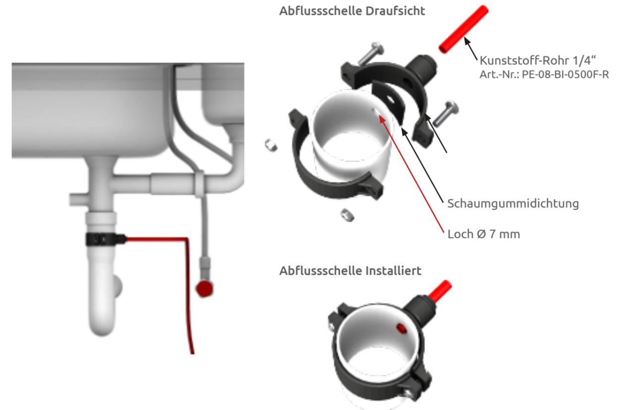
**i** Die Abflussschelle sollte oberhalb des Geruchsverschlusses am Siphon installiert werden.
