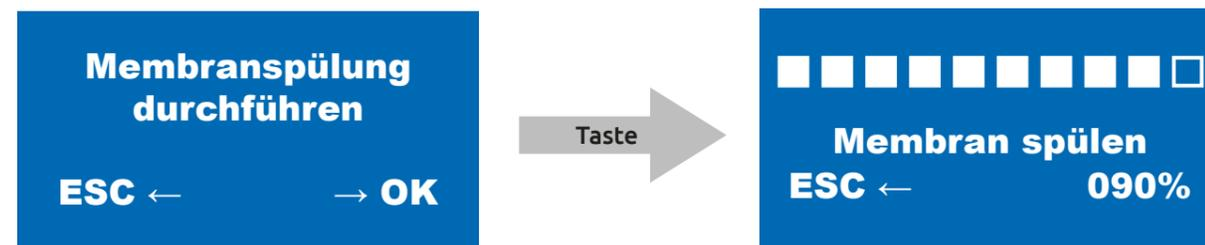
Wenn Sie die Membranspülung mit der **OK-Taste** auswählen, spült das System die Membrane. Mit der **ESC-Taste** gelangen Sie wieder in das Betriebsarten-Menü. Sobald die Spülung beendet ist, geht das System automatisch in das Betriebsarten-Menü zurück.
