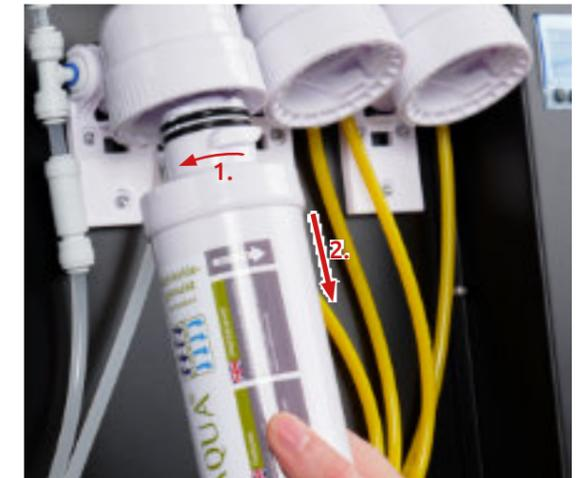
Drehen Sie Filterkartusche um 90° gegen den Uhrzeigersinn aus dem Filterkopf heraus, um die Filtereinheit zu wechseln.
