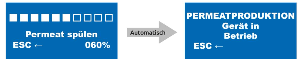
Ist das IB-Programm abgeschlossen und der Wasserhahn offen, wechselt die Verdanium Geo automatisch in die Permeatproduktion. Lassen Sie die Verdanium Geo anschließend für 7 - 10 Minuten arbeiten, damit evtl. verbleibende Desinfektionsreste ausgespült werden, und stellen Sie sicher das alle Rohverbindungen wasserdicht sind.
