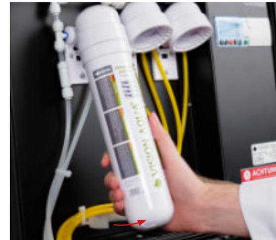
Dank der neigungsbaeren Filterköpfe können Sie den Filterwechsel ohne zusätzliches Werkzeug durchführen. Nehmen Sie die GAC Nachfiltereinheit nach vorne aus der Verdanium Geo hinaus.
