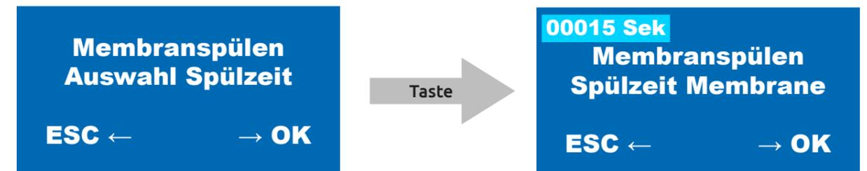
Die Zeit wird jetzt blinken und kann mit der (+)- oder (-)-Taste zwischen 15 und 300 Sekunden verändert werden. Weniger als 15 Sekunden stehen nicht zur Verfügung, um das System vor eventuellen Schäden zu schützen. Bestätigen Sie die Auswahl dann mit der **OK-Taste**.
