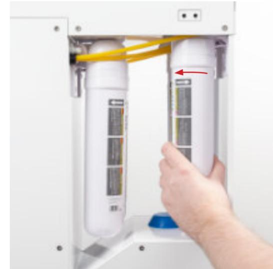
Drehen Sie Filterkartuschen gegen den Uhrzeigersinn um 90° aus den Filterkopf heraus um die Filtereinheit zu wechseln.
