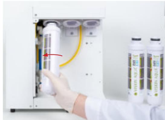
Drehen Sie Filterkartusche gegen den Uhrzeigersinn um 90° aus den Filterkopf heraus um die Filtereinheit zu wechseln.
