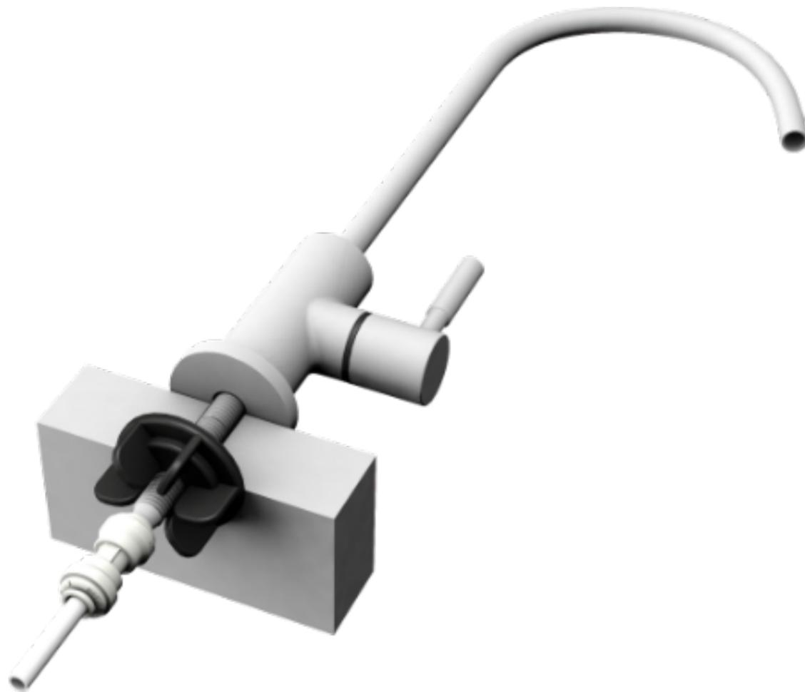
Sowohl der Anschluss am Entnahmehahn als auch an der Verdanium HOME werden unter vollem Leitungsdruck stehen und sollen besonders sorgfältig hergestellt werden. Prüfen Sie deswegen bei geöffnetem und geschlossenem Entnahmehahn beide Anschlussstellen auf Dichtheit.
