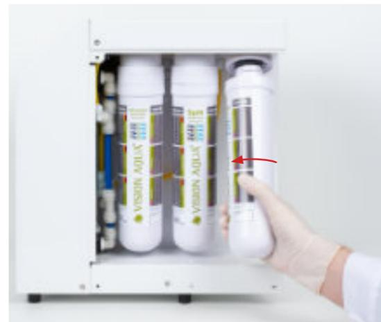
Drehen Sie Filterkartusche gegen den Uhrzeigersinn um 90° aus den Filterkopf heraus um die Filtereinheit zu wechseln.
