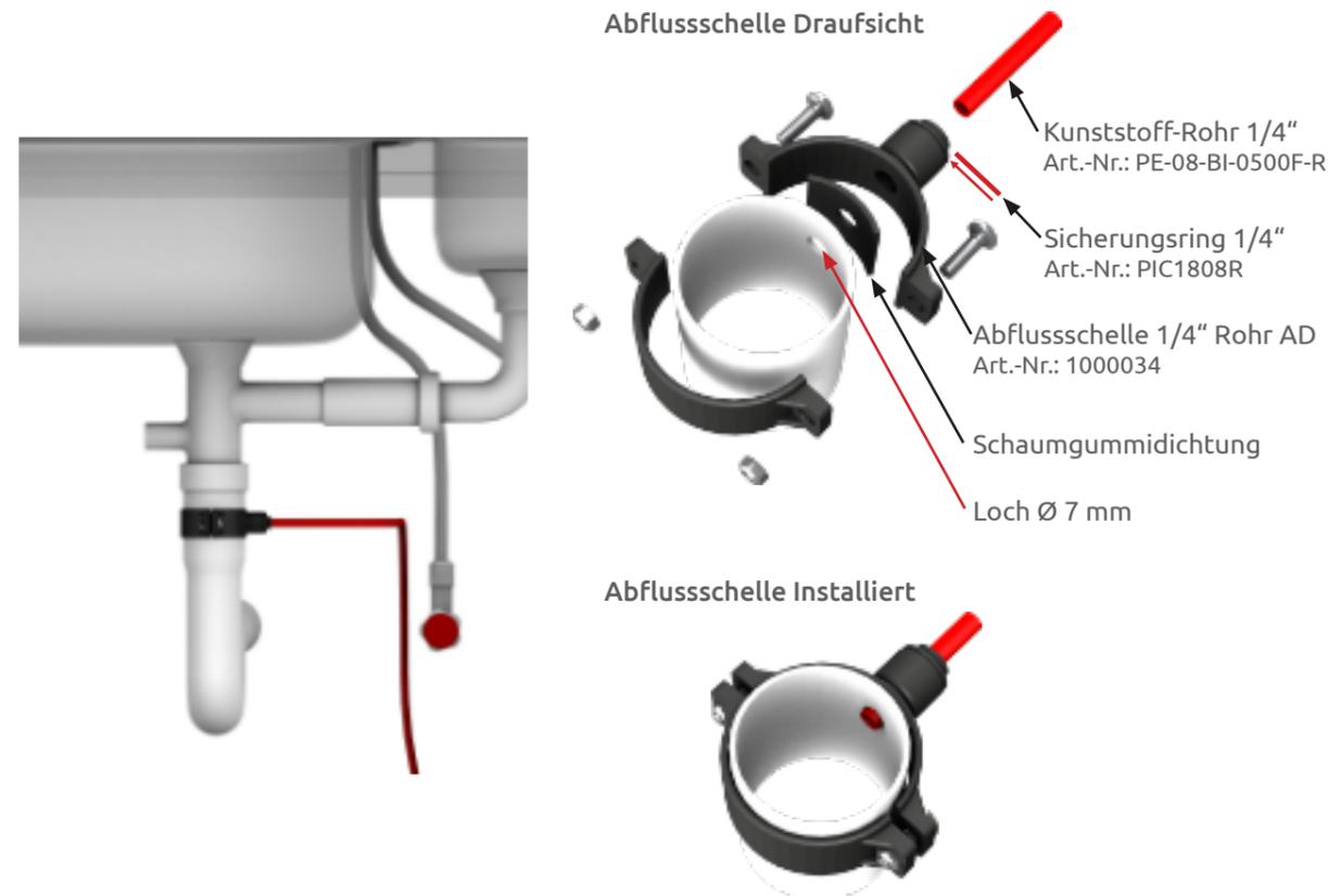
Die Abflussschelle sollte oberhalb des Geruchsverschlusses am Syphon installiert werden.
