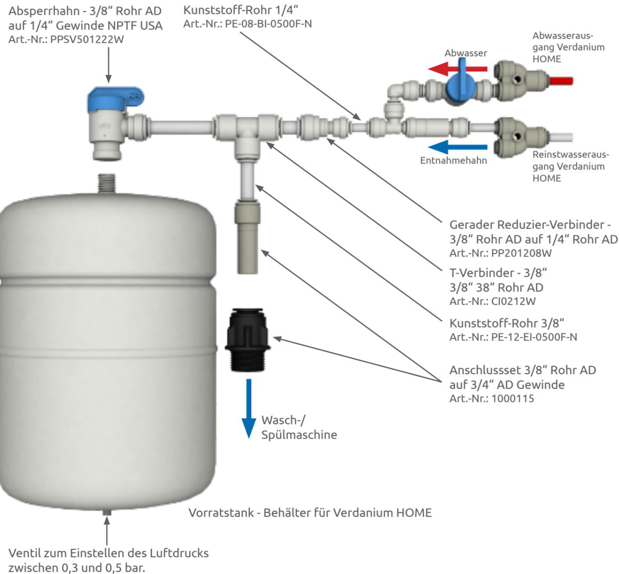
Beim Tankentleeren müssen Sie unbedingt darauf achten, dass der Absperrhahn am Vorratsstank-Anschluss geschlossen ist!
