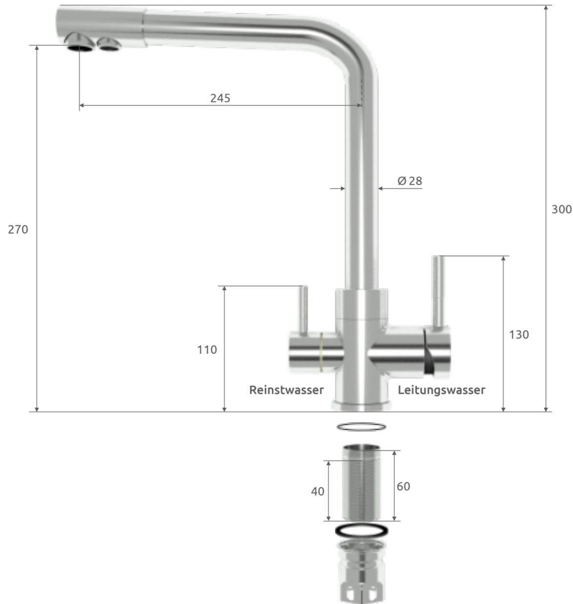
Sowohl der Anschluss am Entnahmehahn als auch an der Verdanium HOME werden unter vollem Leitungsdruck stehen und sollen besonders sorgfältig hergestellt werden. Prüfen Sie deswegen bei geöffnetem und geschlossenem Entnahmehahn beide Anschlussstellen auf Dichtheit.
