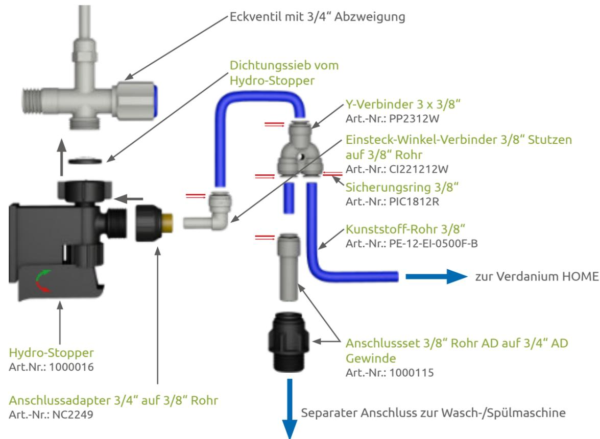
Wechseln Sie die AA LR 6 Batterie alle 7 - 8 Jahre und kontrollieren Sie die ordnungsgemäße Funktion des Hydro-Stoppers bei jedem Filterwechsel.
