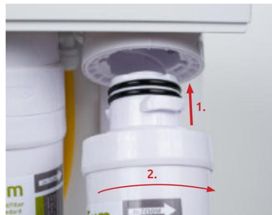
Setzen Sie die neue Filterkartusche in den Filterkopf ein und drehen Sie dabei die Filterkartusche um 90° im Uhrzeigersinn.
