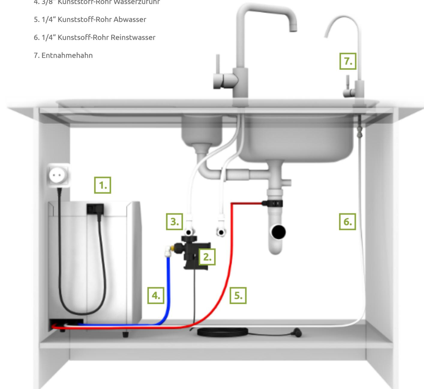
**Die maximale Leitungslänge beim 1/4" Reinstwasser-Rohr beträgt 2 m.
