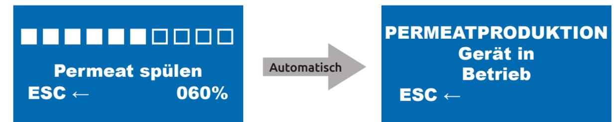
Ist das IB-Programm abgeschlossen und der Entnahmehahn offen, wechselt die Verdanium HOME automatisch in die Permeatproduktion. Lassen Sie die Verdanium HOME anschließend für 7 - 10 Minuten arbeiten, damit evtl. verbleibende Desinfektionsreste ausgespült werden, und stellen Sie sicher das alle Rohverbindungen wasserdicht sind.
