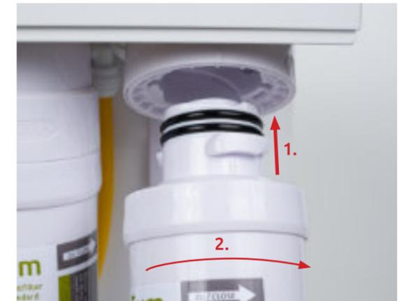
Setzen Sie die neuen Filterkartuschen in die Filterköpfe ein und drehen Sie dabei die Filterkartusche um 90° im Uhrzeigersinn.
