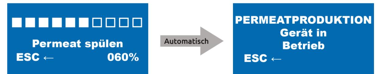
Ist das IB-Programm abgeschlossen und der Entnahmehahn offen, wechselt die Verdanium HOME automatisch in die Permeatproduktion. Ab diesem Moment können Sie die Verdanium HOME verwenden.
