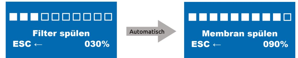
Bei der Spülung der Membranen wird das Desinfektionsmittel aus der Membran entfernt und in das Abwasser geleitet.
