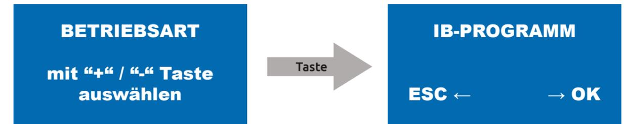
Diese Betriebsart (IB-Programm) setzt immer voraus, dass die Verdanium HOME korrekt angeschlossen ist. Der Wasserzulauf und der Entnahmehahn müssen geöffnet sein.
